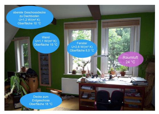
Abb. 3: Im Gebäudebestand ist in der Regel eine Raumtemperatur von 24 °C erforderlich um die Anforderungen an die Behaglichkeit sicherzustellen
