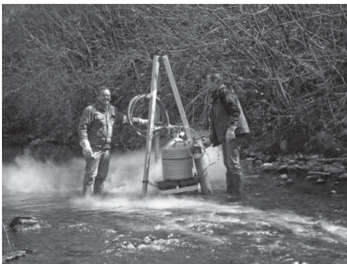
Entnahme von Eiskernproben des Bachsedimentes mithilfe von Flüssigstickstoff
