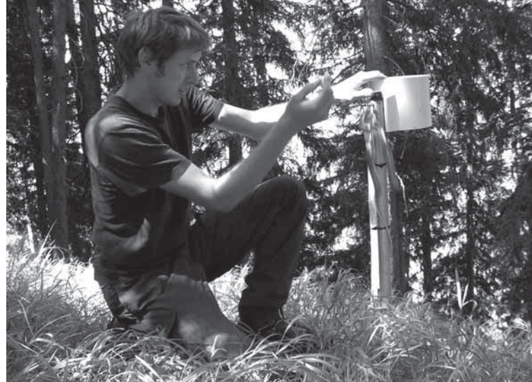
Reparatur des Niederschlagsmessers in den Schweizer Alpen
