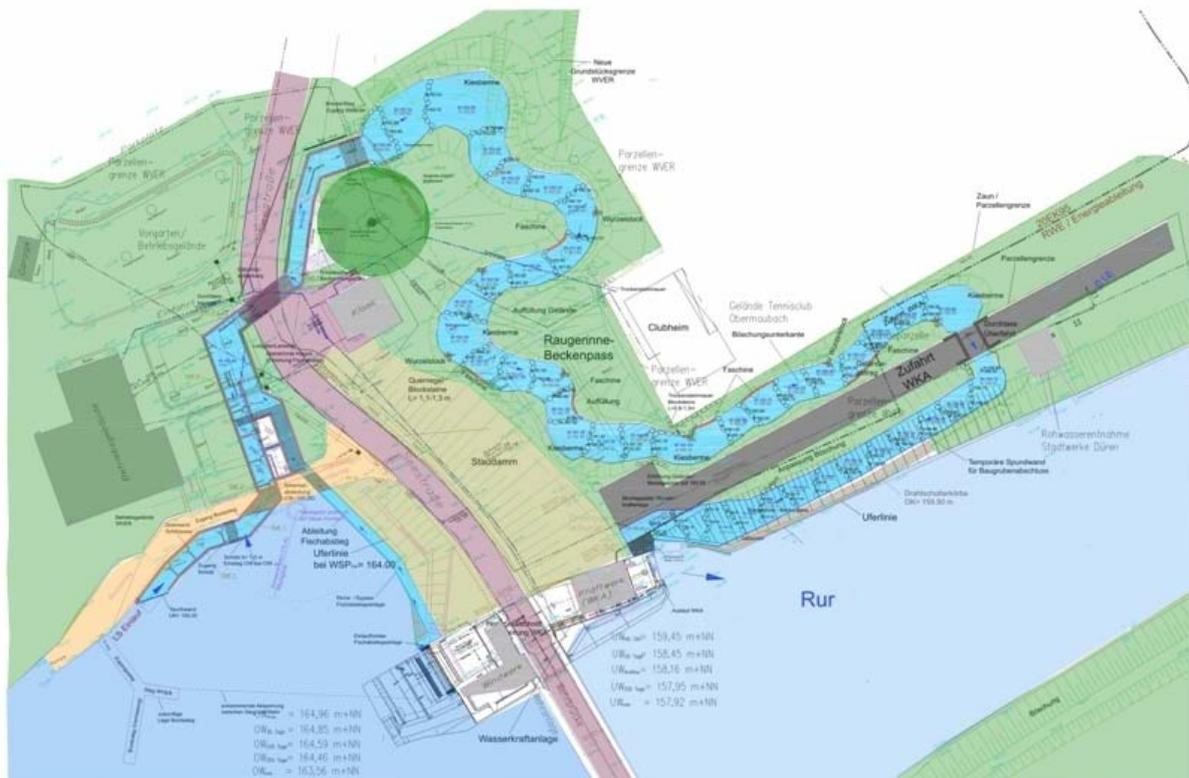
Der Verlauf des Fischpasses um den Staudamm herum (Linie in Türkisblau). Er führt vorbei an der alten Esskastanie (markiert durch den dunkleren, grünen Kreis), von dort zurück an die Rur, parallel zu dieser flussabwärts und nach einer Kehre wieder flussaufwärts bis zum Auslauf des Wasserkraftwerks.
