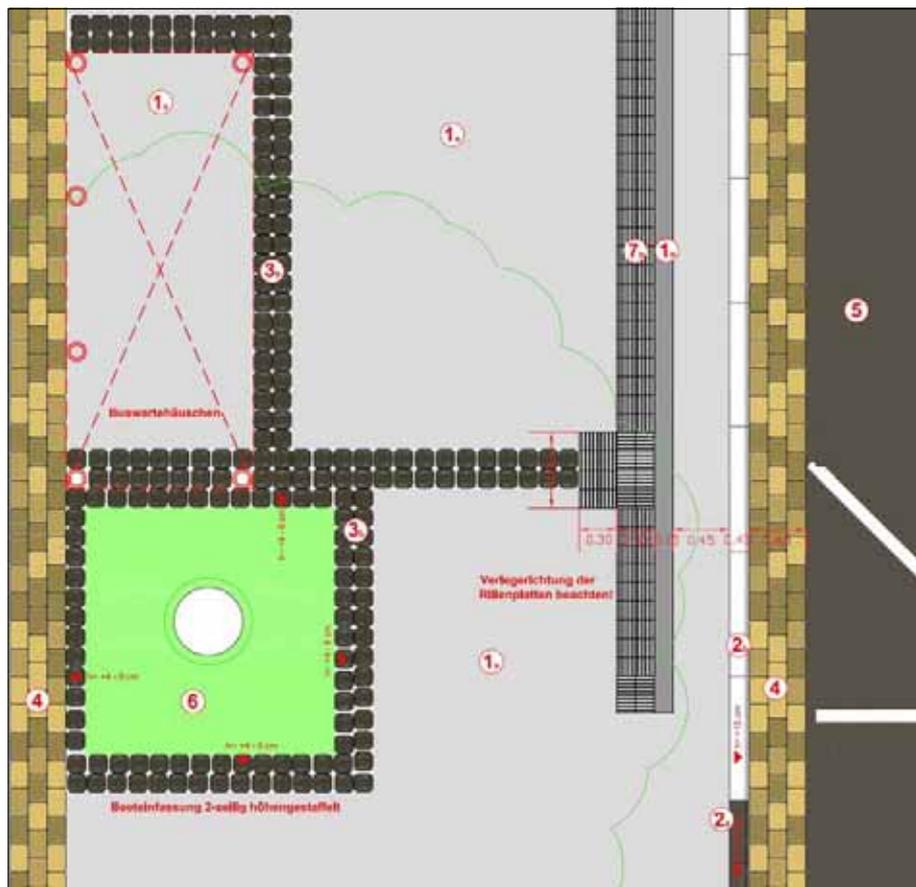
Beispiel für ein Blindenleitsystem an einer Bushaltestelle. Durch den Einsatz von starken Kontrasten an der Fahrbahnkante und üblichem Straßenmaterial wird zwischen Warnen und Richtungweisen unterschieden.
