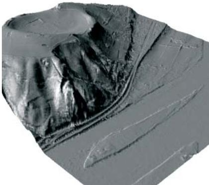
Als Digitales Höhenmodell (DHM) bezeichnet man eine Menge digital gespeicherter Höhenwerte von regelmäßig oder unregelmäßig verteilten Oberflächenpunkten, die die Struktur der Erdoberfläche hinreichend repräsentieren. DHM bezeichnen als Oberbegriff Digitale Geländemodelle (DGM) und Digitale Oberflächenmodelle (DOM).
