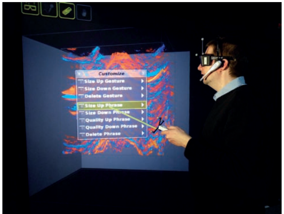
Interaktion mit seismischen Daten in einer virtuellen 3D-Umgebung. Mithilfe eines Eingabegeräts und mittels Sprache und Gesten kann der Benutzer die Darstellungsparameter so beeinflussen, dass geologisch relevante Strukturen sichtbar werden.
