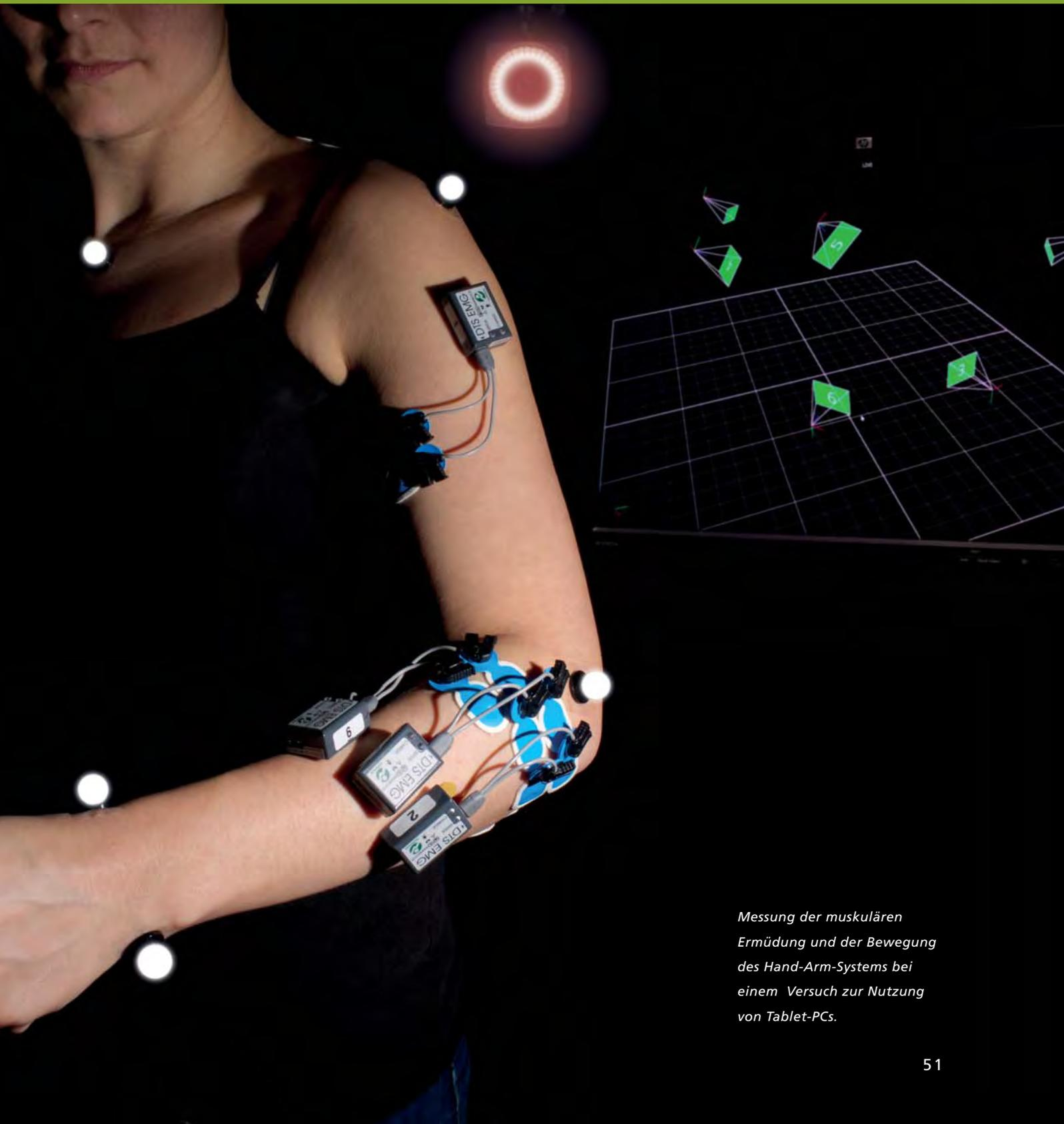
*Messung der muskulären Ermüdung und der Bewegung des Hand-Arm-Systems bei einem Versuch zur Nutzung von Tablet-PCs.*
