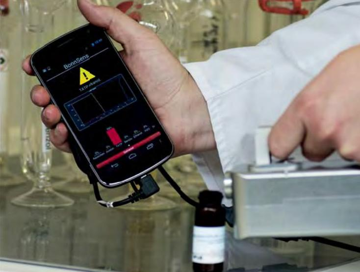
Detektion von TATP mit Hilfe des entwickelten Messgeräts.
