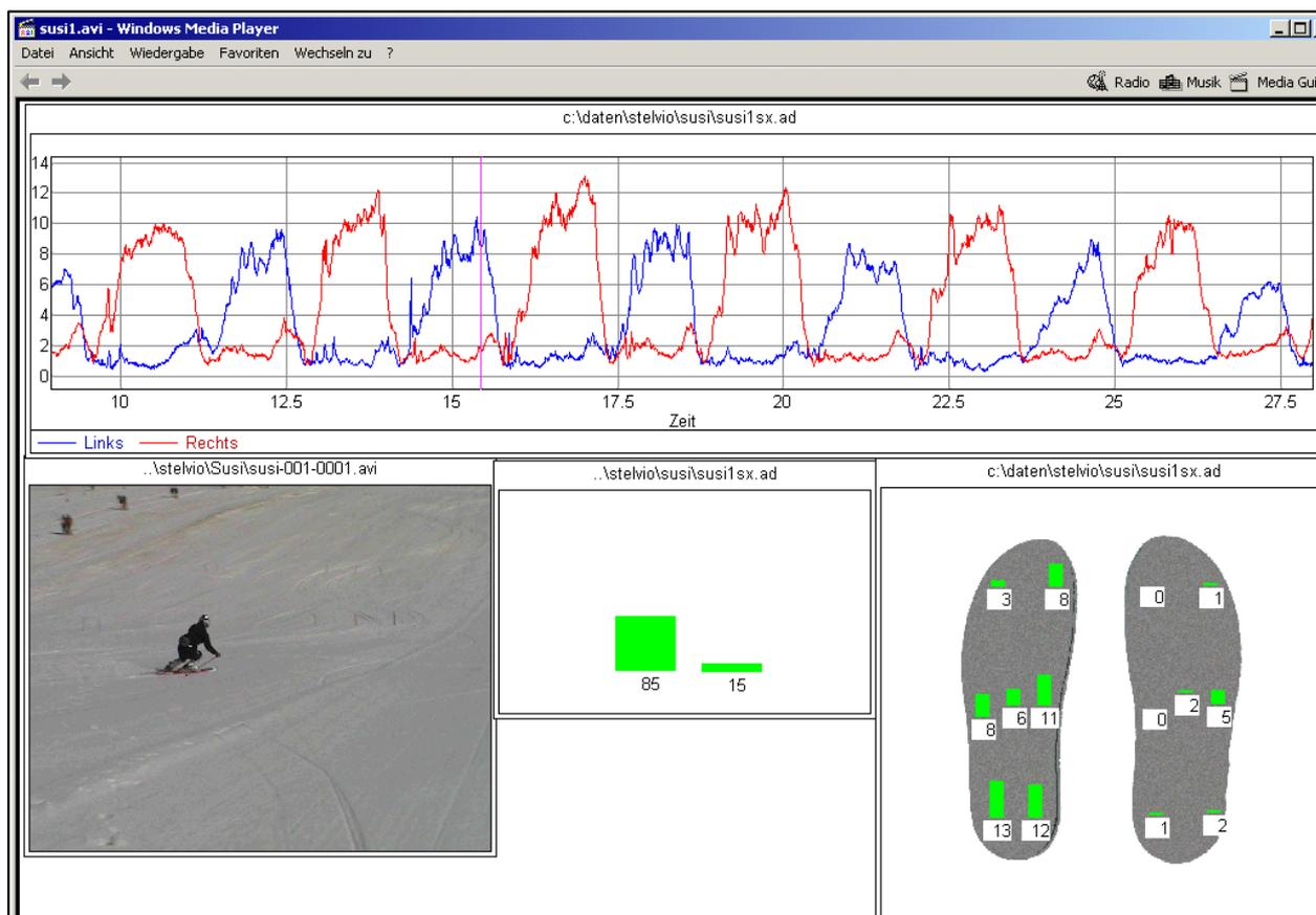
Abb. 5 Messung der Druckverhältnisse an der Fußsohle im freien Fahren ohne Zusatzaufgabe.
