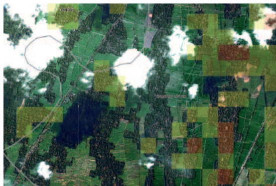
Schadenskartierung mit Hilfe von QUICK-BIRD-Daten von Bantul, Indonesien, nach dem Erdbeben im Mai 2006
