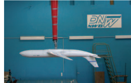
Sämtliche Rotationsbewegungen um die modellfesten Achsen, sowie Hub- und Seitenschlagbewegungen können mit einer hohen Präzision mit diesem Simulationssystem realisiert werden
