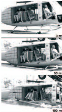
HeliSafe TA: Simulation von Hubschrauber Crash Test mit DLR Hybrid-Rechenmodell
