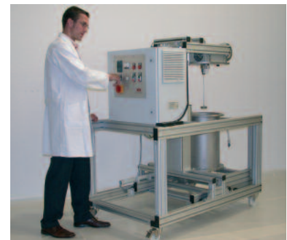
Mikrowellen Harzerwärmungsanlage zur Prozessbeschleunigung
