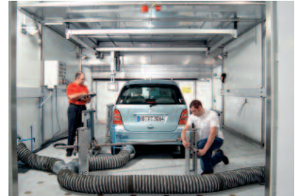
Untersuchung eines Brennstoffzellen-konzeptfahrzeugs im klimatisierter Rollenprüfstand mit Abgasanalyse des Instituts für Fahrzeugkonzepte am DLR-Standort Stuttgart
