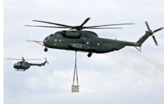
Transporthubschrauber CH-53 G im Test mit 4 Tonnen Außenlast und Leichthubschrauber Bo 105 der Bundeswehr
