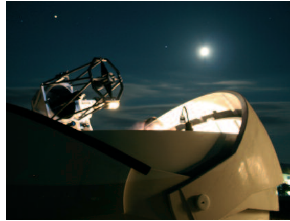
Aufnahme der transportablen Station zur optischen Freiraumkommunikation in Oberpfaffenhofen während des ersten erfolgreichen Empfangs
