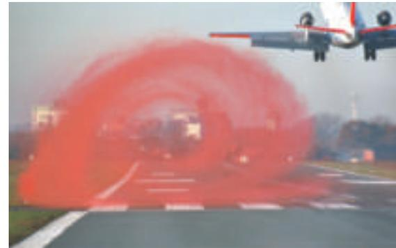
Die Wirbel des ATTAS, hier beim Start des VFW 614, wurden erstmals mit einem LIDAR von einem anderen Flugzeug (Falcon) aus vermessen
