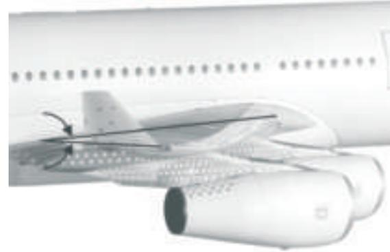
Biegung und Verwindung am aeroelastisch deformierten Flügel
