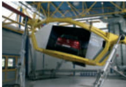
Der dynamische Fahrsimulator ermöglicht die realitätsnahe Erprobung von Assistenzsystemen
