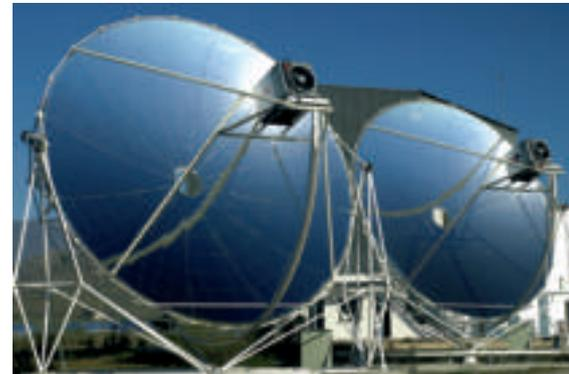
Dish/Stirling Prototypen in der Erprobung auf der Plataforma Solar de Almeria
