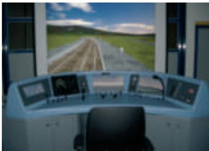
2D-Visualisierung im Führerpult des RailSiTe
