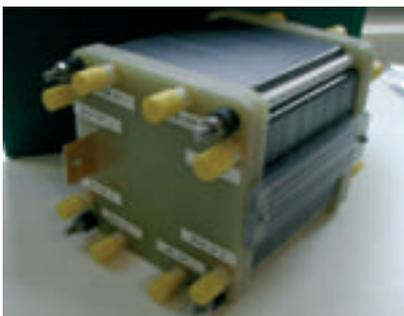
Direkt-Methanol-Brennstoffzellenstapel mit 1 kW Leistung
