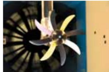
Propeller mit druck- (magenta) und temperatursensitiver (gelb) Beschichtung im Windkanal
