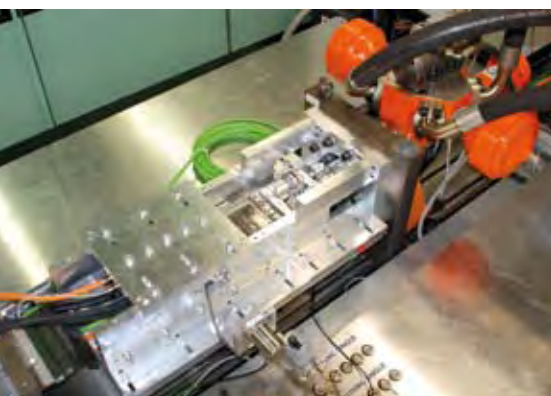
FKLG montiert auf dem Prüfstand
