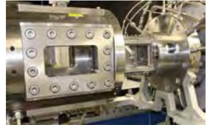
Hochdruckprüfstand für Oxyfuel-Verbrennungsprozesse mit optischem Zugang für Lasermessungen
