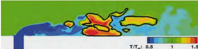
Normierte Temperaturverteilung eines wasserstoffhaltigen Luft-Brennstoffgemischs nach einer Selbstzündung. Die schwarzen Linien zeigen die Grenzen der Flammenzonen.
