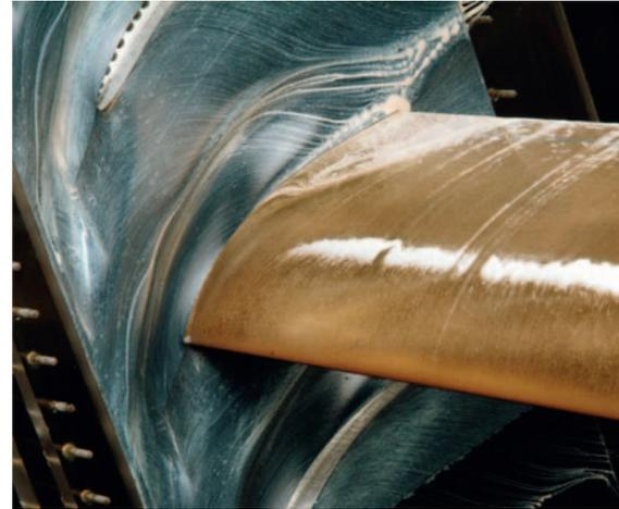
Anstrichbild eines Verdichtergitters mit nicht-rotationssymmetrischer Seitenwandkonturierung
