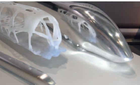
Silberfarben: Windkanalmodell zur Untersuchung von Seitenwindstabilität und Widerstandsoptimierung. Helle Gitterstruktur: Design-Entwurf zur Topologieoptimierung
