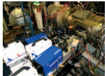
Experimentelle Analyse des Zündprozesses am Prüfstand bei Rolls-Royce mit Hochgeschwindigkeitskameras
