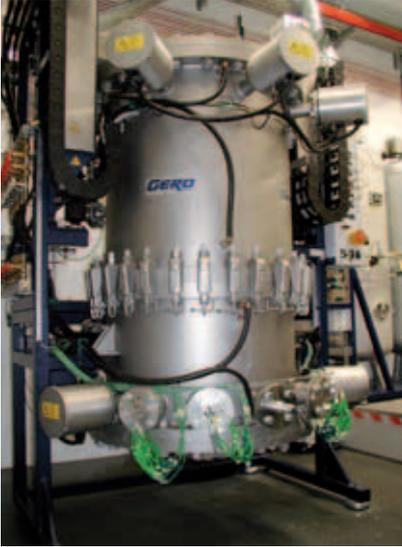
Inbetriebnahme Teststand zur Charakterisierung von SOFC bei erhöhtem Druck: Druckaufgeladener Betrieb (1-8 bar)
