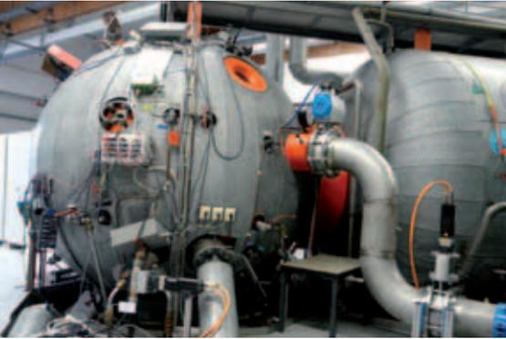
Druckkammeranlage für bemannte Versuche. Schnelle Druckprofile werden über großvolumige Rohrverbindungen mit rechnergesteuerten Servoventilen erreicht
