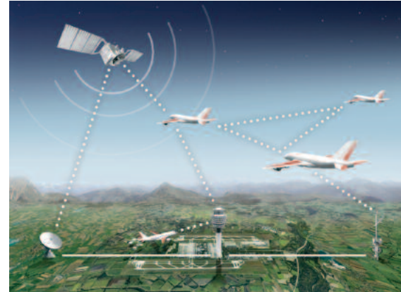
Vernetzung von Flugzeugen über verschiedene Datenlinks für die Cockpit- und Passagierkommunikation
