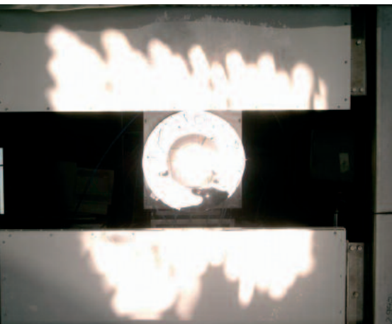
Testreaktor in Betrieb im Sonnenofen des DLR in Köln
