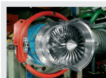
Links: Aufbau des UHBR Rigs am M2VP des DLR Köln, rechts: Kennfeld im Vergleich mit den Vorhersagen
