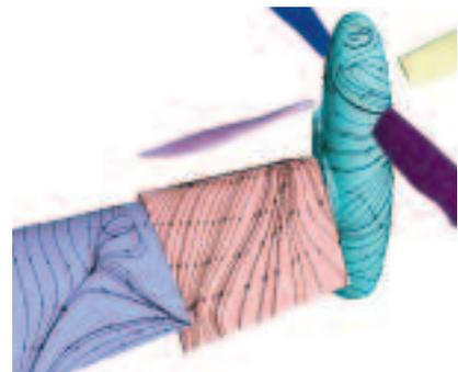
Verlauf der Stromlinien auf der Oberfläche des TILTAERO-Halbmodells
