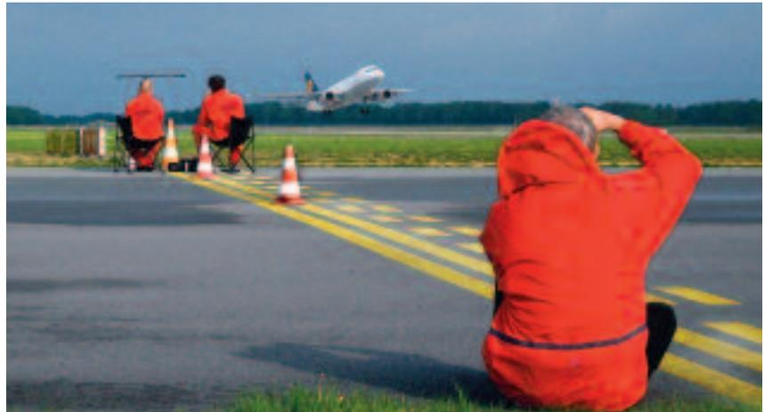
Lärmmessung bei den lärmarmen An- und Abflugverfahren
