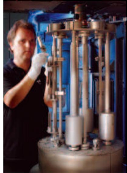
Einbau einer Turbinenschaufel zur Beschichtung in der neuen Multiquellen-Magnetron-Sputter-Anlage MEGA
