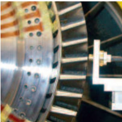
Montage der Messstrecke: Nabenkantur in der Abströmung (oben) und die Kontrolle des Schaufelspitzenradius nach dem Aufstecken des Rotors (unten)
