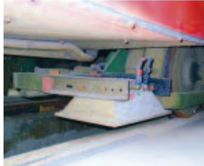
Weichenerkennung und somit Positionsbestimmung mit einem Wirbelstromsensor unter dem Zug
