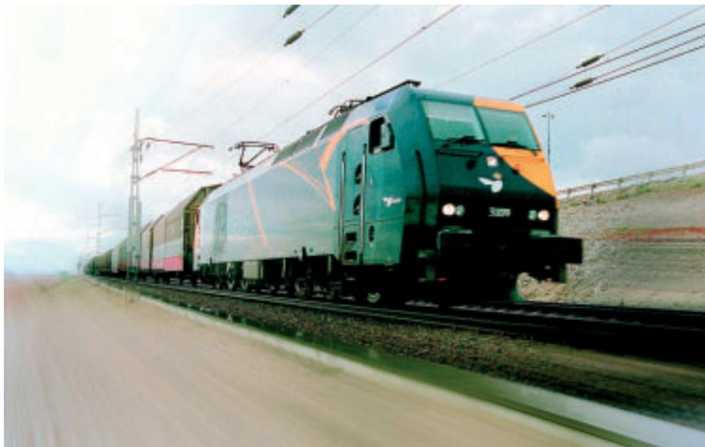
Die Eisenbahnen stellen ihre Leistungsfähigkeit unter Beweis. Diese dänische Mehrfrequenzlok BR EG 3100 ist z.B. für den Railonverbund und die schwedische Green Cargo zwischen Deutschland, Dänemark und Schweden unterwegs
