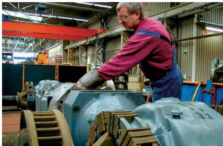
Montage eines Fahrmotors zwischen zwei Radsatzgetriebe
