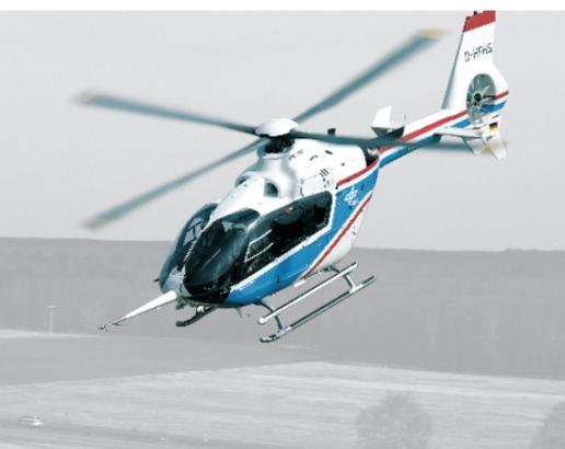
Fliegender Hubschrauber-Simulator (ACT/FHS) mit Fly-by-Light- und Fly-by-Wire-Steuerung
