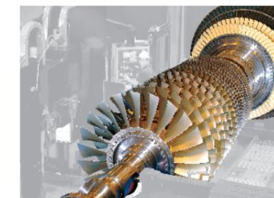
Gasturbinenläufer mit Verdichterschaufeln im Vordergrund und Turbinenschaufeln im Hintergrund
