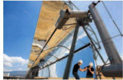
Spiegel im Test: Qualitätsuntersuchungen auf der Plataforma Solar in Almería (Südspanien)
