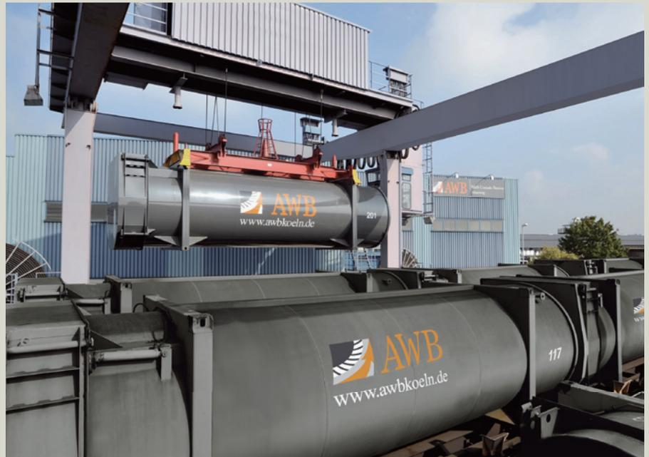
Vor dem Transport in die Restmüllverbrennungsanlage wird der Kölner Müll in den beiden Umladestationen geruchsdicht in Container verpackt.
