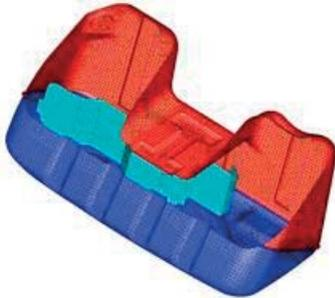
Simulation des Schwappens von Benzin im Tank © Daimler Chrysler AG
