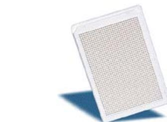
Bild 1: Abbildung einer Mikrotiterplatte für das High-Throughput Screening. Die Platte hat 1536 winzige Vertiefungen, in denen die einzelnen Experimente parallel durchgeführt werden.
