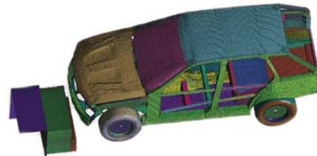
Crashtest-Modell und seitlich versetzte Barriere. Die Bauteile sind unterschiedlich eingefärbt.
