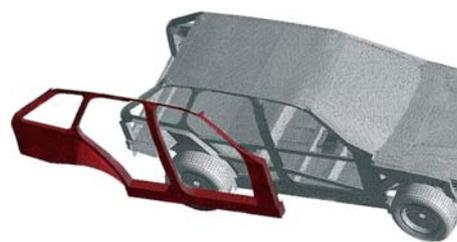
Zerlegung des Modells in Bauteile. Der Seitenrahmen (rot) besteht aus einem Finite-Elemente-Netz aus ca. 10 000 Maschen.
