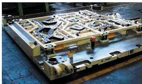
Bild 1: Stanzwerkzeug zur Verschachtelung von Blechteilen
