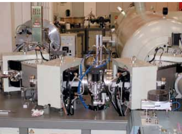
Projekt »Radiokarbondatierung der Bronzezeit in der südlichen Levante«: Massenspektrometer der Universität Oxford. Das Gerät wird zur Altersbestimmung von kohlenstoffhaltigen, insbesondere organischen Materialien eingesetzt.
