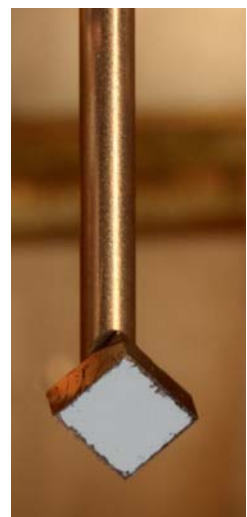
Vakuumsaugnapf mit einer Probe für Gitterschwingungsmessungen.
