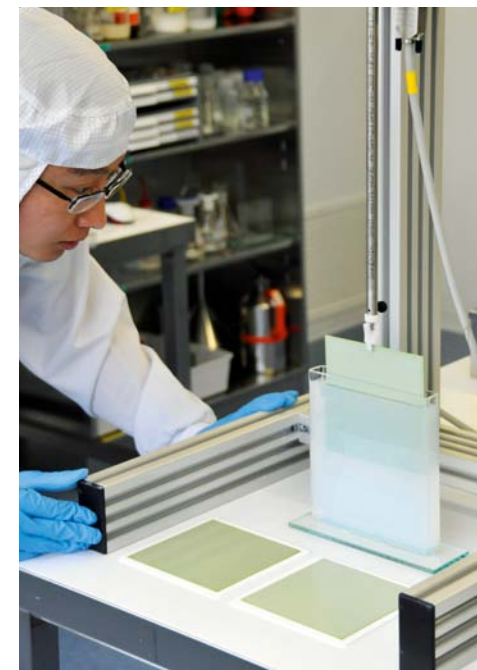
Die Herstellung der dünnen Elektrolytschicht einer Brennstoffzelle durch Tauchbeschichtung. Dabei wird ein Trägermaterial zunächst in eine Flüssigkeit, das „Sol“, eingetaucht und dann mit konstanter Geschwindigkeit herausgezogen.
