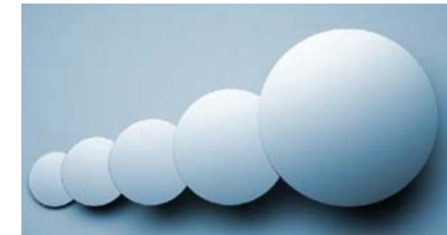
*Ganz rechts ein heutiger 300-Millimeter-Wafer. Links ein Silizium-Wafer mit einem Durchmesser von 100 Millimetern, wie er vor rund 30 Jahren in der Industrie Standard war.*
