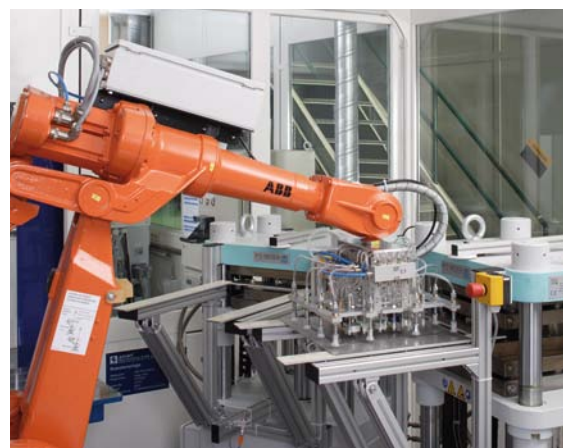
Um eine höhere elektrische Spannung zu erhalten, werden mehrere Brennstoffzellen zu einem Stack (rechtes Bild) zusammengesetzt. Diese Arbeit erledigt ein Roboterarm (oberes Bild).
