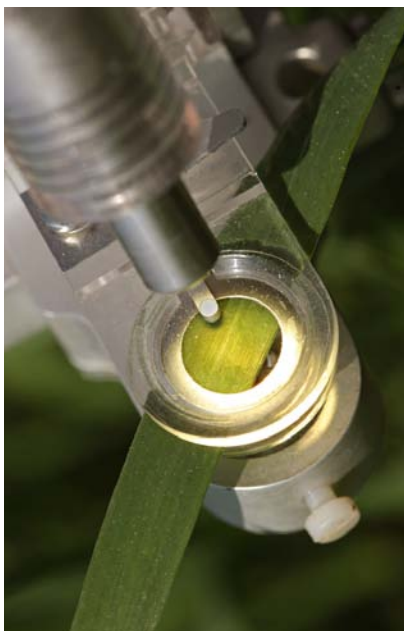
Hier wird die Fluoreszenz eines Blattes gemessen und daraus die Fotosyntheseaktivität der Pflanze bestimmt.
