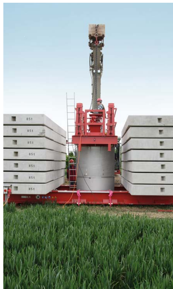
Ausgestochene Bodenstücke in so genannten Lysimetern helfen zu verstehen, welche Rolle das Wasser und die Bodenstruktur beim Transport von Stoffen spielt, und wie Klimaveränderungen diese Prozesse beeinflussen.
