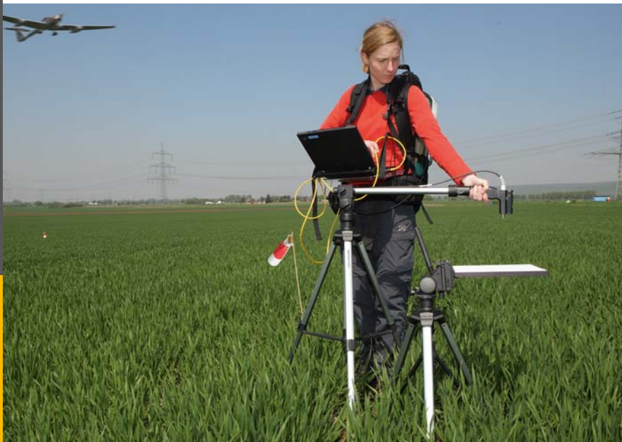
Mit einem Spektrometer ermittelt Anke Schickling die von der Oberfläche reflektierte Sonnenstrahlung; im Hintergrund das Messflugzeug „Eco-Dimona“, das die Konzentration von Wasser und Kohlendioxid in der Atmosphäre misst.
