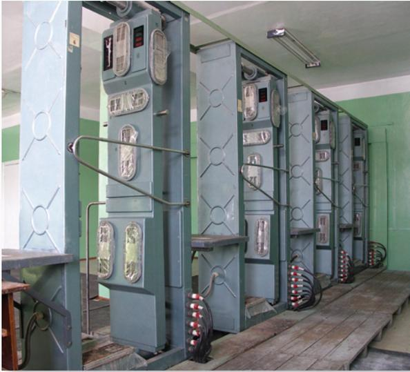
◀ Messeinrichtung zur Kontrolle auf radioaktive Kontamination vor dem Verlassen der 30-km-Zone
