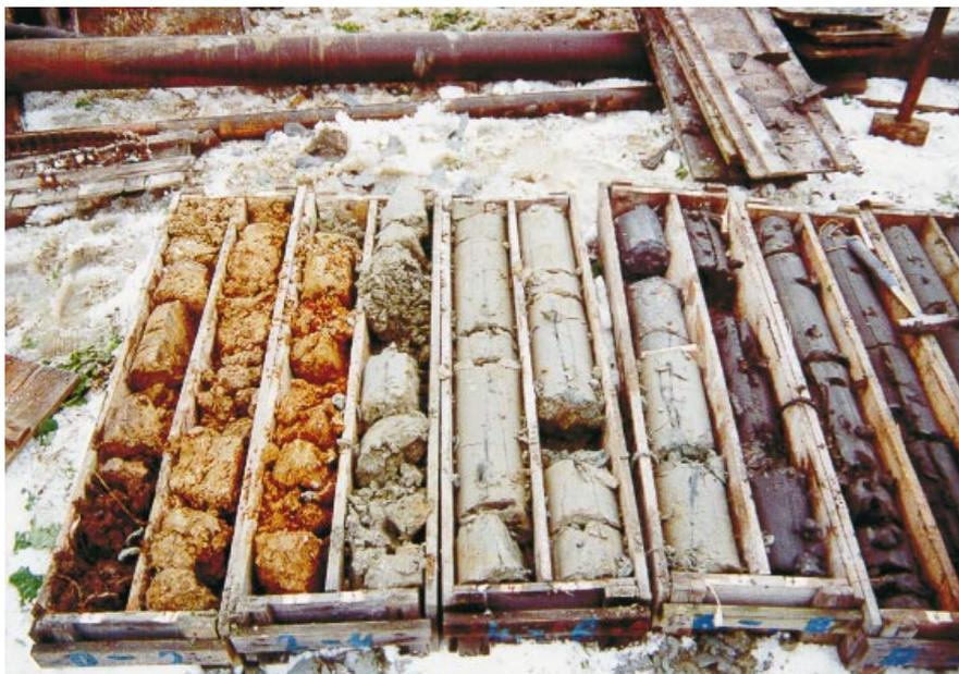
Bohrkerne für chemische, mineralogische, sedimentologische und radiometrische Untersuchungen im Labor. Der Farbwechsel dokumentiert den Übergang von quartären (hell) zu tertiären Sedimenten (dunkel)
