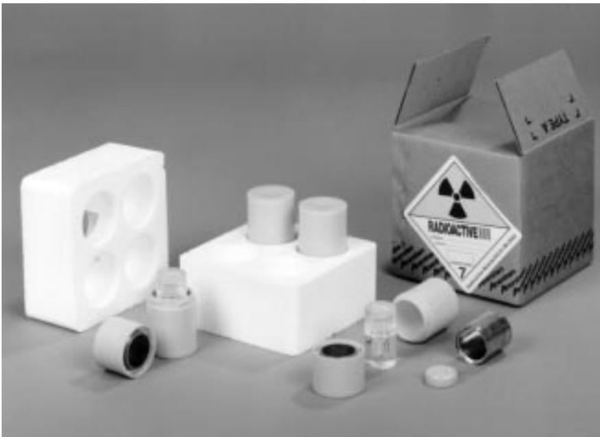
Typischer Aufbau und Komponenten von Typ A-Versandstücken
