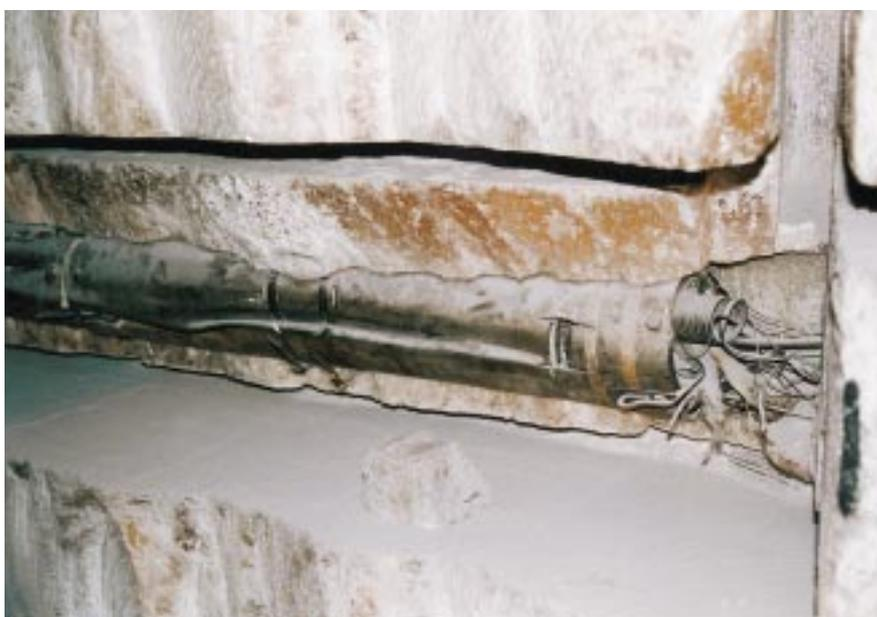
Versuchseinrichtung zur Untersuchung von Wärmeeinwirkung auf Salz
