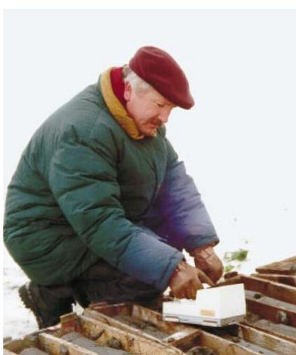
Gammasspektrometrische Untersuchungen an Bohrkernproben
