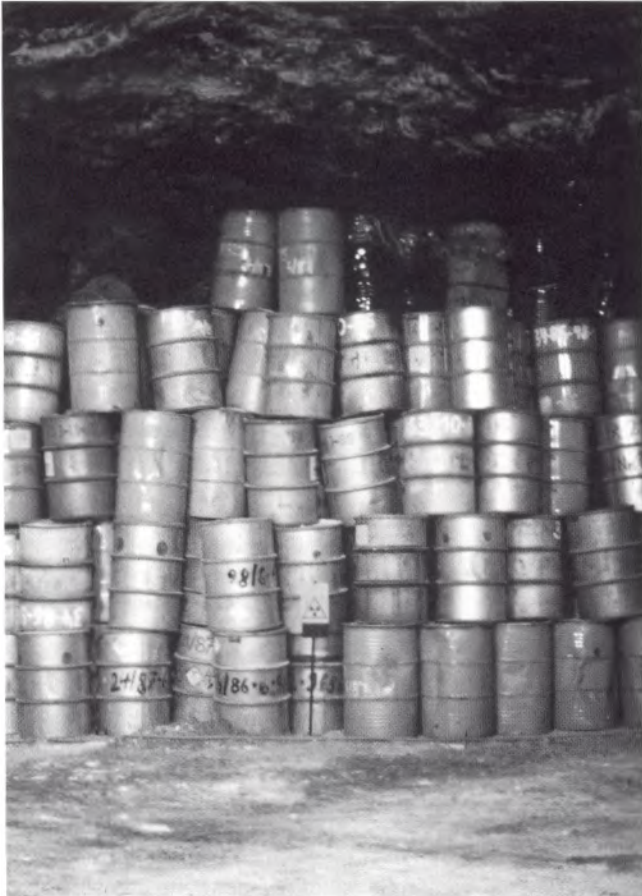
Bild 3.8: Gestapelte Fässer mit festen radioaktiven Abfällen
