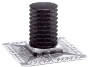
Bild 5.44: Logik-Chip. Ein Logik-Chip enthält 400 Schaltkreise mit einer Schaltzeit von 400 Picosekunden. Die gesamte Logik eines 580-Prozessors ist auf etwas mehr als 600 solcher Chips untergebracht.
