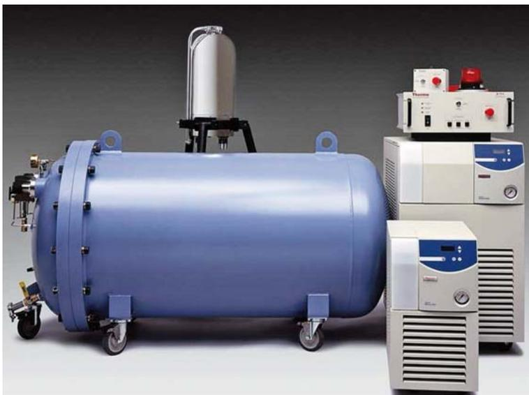
Abb. 10: Komponenten des neuen Neutronengenerators D-711: Die Neutronen werden in dem silbrigen Neutronendom erzeugt, der die eigentliche Neutronenröhre enthält, auf dem Bild zu finden hinter dem großen blauen Zylinder, der Hochspannungskaskade. Die Geräte rechts im Bild sind Kühl- und Steuergeräte.
