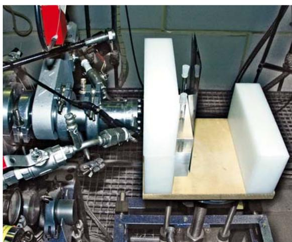
Abb. 8: Untersuchungen am früheren Neutronengenerator SAMES des INT zur Neutronenradiographie: Ein Testobjekt aus Plastik mit Glasröhrchen wird mit Neutronen durchstrahlt und eine Dysprosium-Folie aktiviert. Anschließend wird die Folie auf einer Bildplatte autoradiographiert. Die Bildplatte wird mit einem speziellen Scanner ausgelesen.
