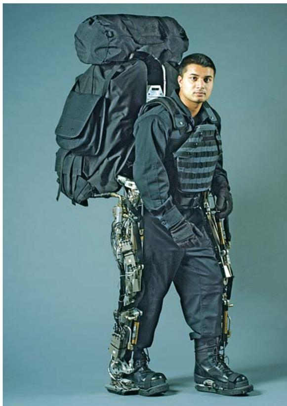
Abb. 2: Prototyp eines Exoskeletts als mechanische Tragehilfe
