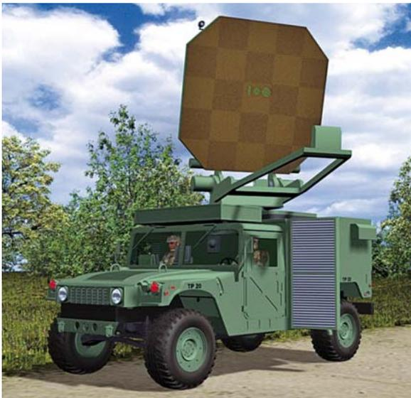
Abb. 5: Möglicher Aufbau einer mobilen Hochleistungs-Mikrowelle. (Quelle: Air Force Research Laboratory)
