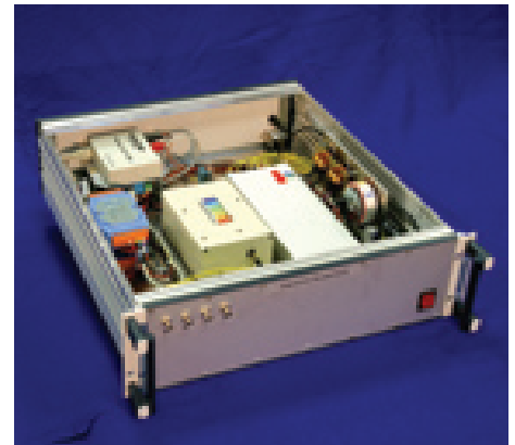
Abb. 12: Ein Teil des neu entwickelten Spektrometersystems. Es ermöglicht die permanente Überwachung der eingesetzten Glasfasern und dient der rechtzeitigen Planung einer Erneuerung der geschädigten Fasern. Zu sehen sind die verschiedenen Komponenten zur Computersteuerung und Datenübermittlung. Die Datenauswertung und Steuerung ist weltweit über das Internet möglich.
