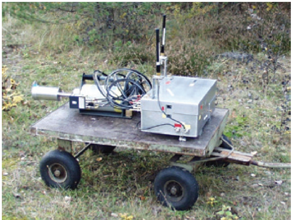
Abb. 19: Teleskopdetektor mit Funkdatenübertragung bei einer Messung im Gelände. Die Metallbox beinhaltet neben den Funkmodulen und den außen angebrachten Antennen die Inspektoren (Analyse-Einheit und Hochspannung).
