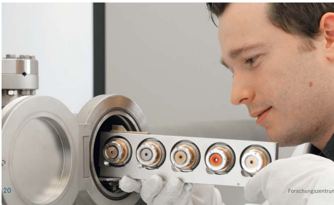
Forscher analysieren die neue Stahl-Legierung auf chemische Veränderungen der Oberflächen für den Einsatz in der Brennstoffzelle (SOFC).
