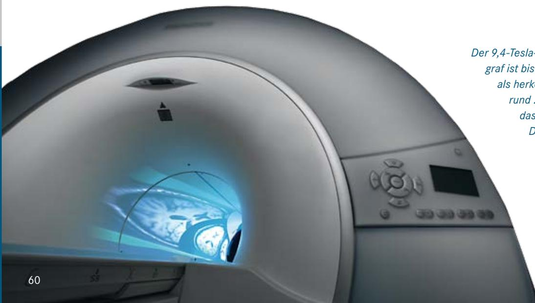
*Der 9,4-Tesla-Magnetresonanztomograf ist bis zu sechsmal stärker als herkömmliche Geräte und rund 200 000-mal stärker als das Magnetfeld der Erde. Damit wollen Hirnforscher zukünftig die genauen Mechanismen für neurodegenerative Erkrankungen auf molekularer Ebene untersuchen.*
