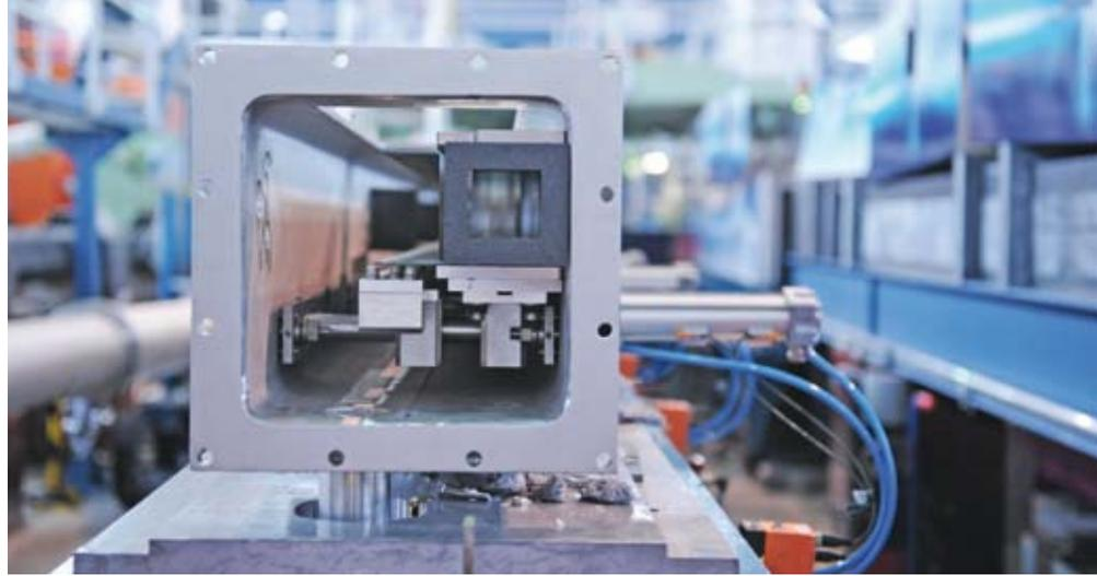
Blick in die Bündelungsstrecke der KWS 2 während des Umbaus Ende des Jahres 2010: Man sieht das Vakuumgehäuse, welches das Neutronenleitersystem beinhaltet. Im rechten Anschlag befindet sich ein ein Meter langer Neutronenleiter, welcher über die Druckzylinder (rechts) hinein- und herausgefahren werden kann. Zudem führt das Schlittensystem auch die magnetische Führung für die polarisierten Neutronen.
