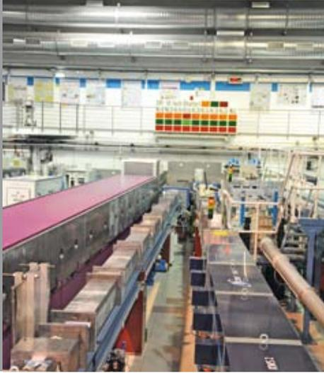
Blick vom Probenort der Kleinwinkelstreuanlage KWS 2 zurück auf die Reaktorwand: Man sieht die Strecken, auf denen der Neutronenstrahl gebündelt wird, rechts in der KWS 2, links in der KWS 1. Weiter hinten sind die Neutronengeschwindigkeitsselektoren in der Bleiabschirmung zu sehen. An der Reaktorwand ist die Versorgung aller Instrumente mit Neutronen angezeigt.
