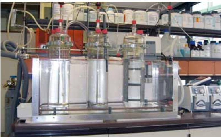
Abb. 12: Aufgebaute Laborversuchsanlage: Reaktorbecken
