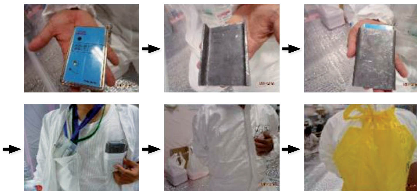
Abb. 5.16: Beispiel für eine entdeckte Manipulation der Messung der Strahlenexposition: Abschirmung aus Blei, in die das APD eingelegt wird, damit das APD eine niedrigere Dosis misst (Quelle: IAEA).
