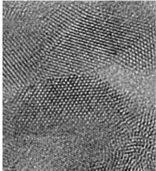
**Abbildung 4: Hochauflösungsaufnahmen von Gold-Nanopartikeln, ohne (links) und mit (rechts) Cs-Korrektor.** Ohne Cs-Korrektor lässt sich nicht zweifelsfrei feststellen, wo die Goldatome lokalisiert sind (s. Pfeil). Im rechten Bild befinden sich alle Goldatome in derselben Fokusebene; sie erscheinen alle weiß.
