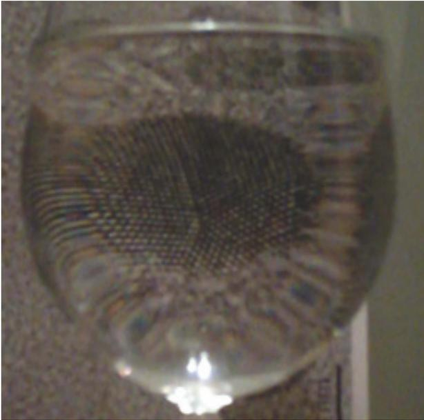
**Abbildung 3: Ein gefülltes Weinglas demonstriert die optische Qualität einer Magnetlinse.** Nur im Zentrum des gefüllten Weinglases, nahe der optischen Achse, ist die vergrößerte Abbildung störungsfrei.
