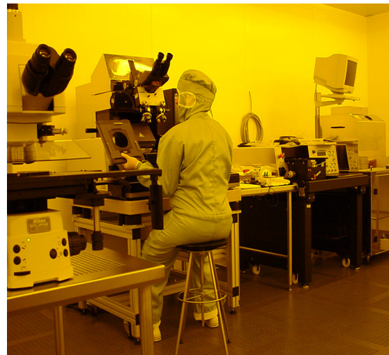
Abb. 1: Fotolithographie: Mask-/Bondaligner (Mitte), Bonder (rechts).
