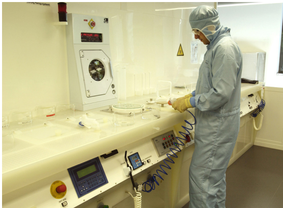
Abb. 2: Nasschemisches Ätzen: Flusssäurebank, Rinser/Dryer (Mitte, oben).
