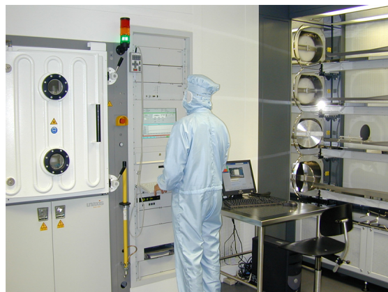
Abb. 3: Beschichtungsbereich: Diffusionsöfen (thermische Oxidation, LPCVD; rechts), Aufdampfanlage (links).
