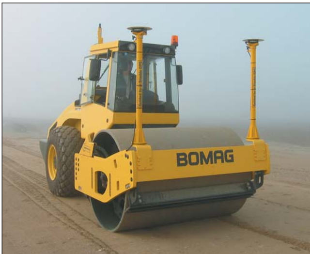
Abb. 1: Baumaschinensteuerung (Abbildung mit freundlicher Genehmigung der Firma BOMAG GmbH, Boppard)
