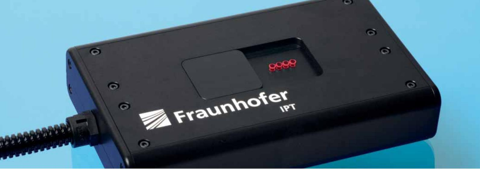
Inline-Messsystem für die Lasermaterialbearbeitung. Dabei werden die Bearbeitungsoptiken dazu genutzt, einen Messstrahl auf die Bauteiloberfläche zu fokussieren. So können Laser- und Messstrahl gleichzeitig arbeiten. Eine telezentrische Abstands- und Topographiemessung in Maschinenkoordinaten ist mit diesem System vor, während und nach der Bearbeitung ausführbar.
