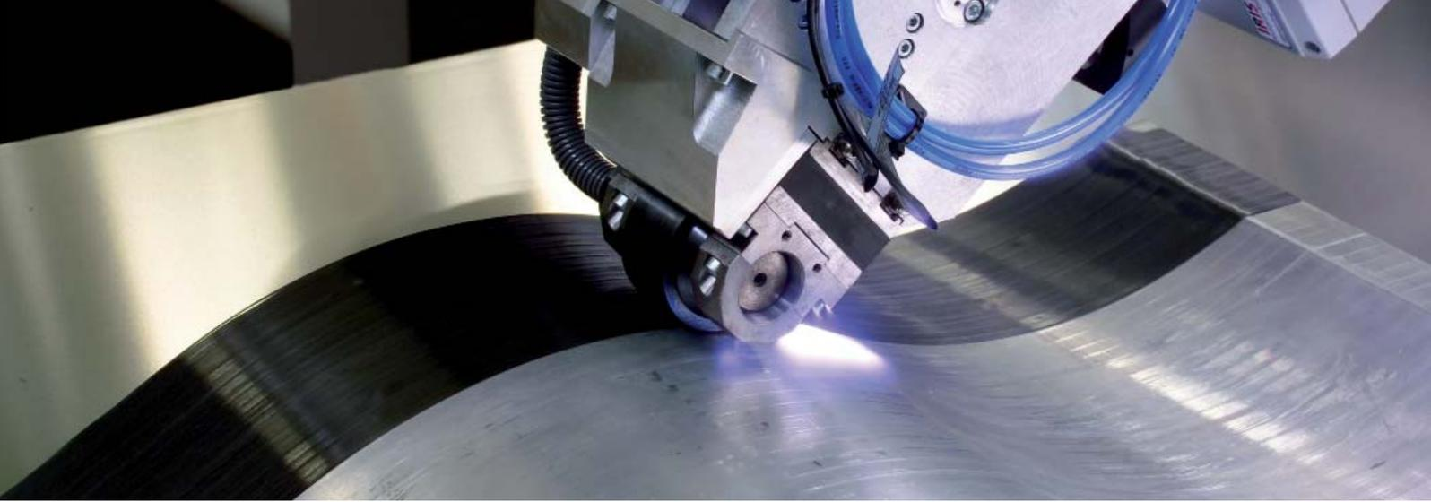
Ziel ist es, die bisher überwiegend manuellen Ablege- und Drapier-Prozessschritte in der industriellen Produktion von FVK-Bauteilen zu automatisieren.
