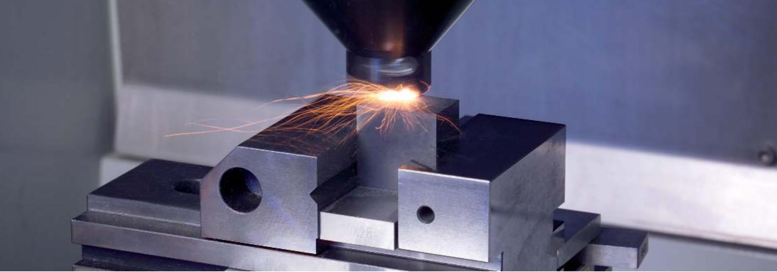
Innerhalb des InnoNet-Verbundprojekts »Hybrid-Punch« (Förderkennzeichen: IN-7026) integrierte das Fraunhofer IPT ein Laserscannersystem in eine C-Gestell-Stanz-/Nibbelmaschine, um unterschiedliche Laserbrennfleck-Konturen entsprechend der Stanzgeometrien schnell und einfach auf der Blechoberfläche zu variieren. Die Mechanismen der Werkstoffentfestigung übertrug das Fraunhofer IPT vom Scherschneiden nun auch auf das Tiefziehen, Fließpressen und Biegen.
