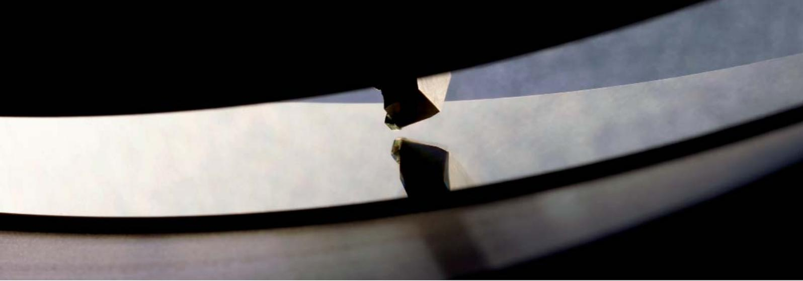
Herstellung solch großflächiger Bauteile, in deren Oberflächen Strukturen mit Abmessungen von wenigen tausendstel Millimetern eingebracht werden, stellt die Produktionstechnik vor bislang unlösbare Probleme.
