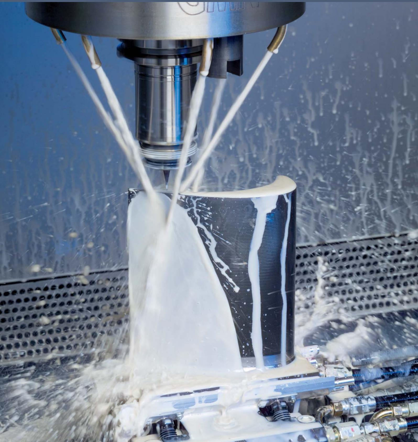
Die Abteilung »Hochleistungszerspanung« bietet anwendungsnahe Fertigungslösungen für Komponenten des Turbomaschinen-, Flugzeug- und Werkzeugbaus. Im Vordergrund stehen das simultane Mehrachsfräsen und das Drehen geometrisch anspruchsvoller Bauteile aus Superlegierungen, hochharten Stählen sowie Leichtbau- und Verbundmaterialien.
