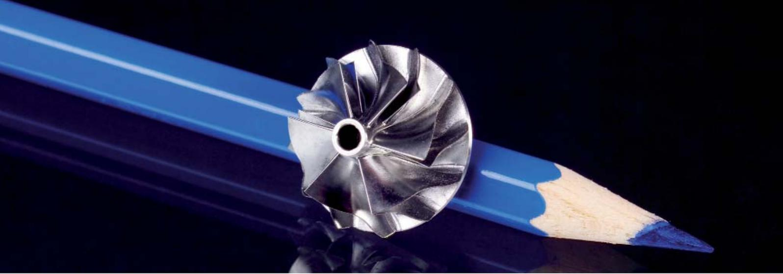
Der optimierte NC-Code enthält darüber hinaus eine lokal vorschubangepasste Drehzahl der Werkzeugspindel, die den »Vorschub pro Zahn« konstant hält – denn dies gilt als wichtiges Kriterium für die Prozessstabilität. Indem die Spindeldrehzahl genau an den Vorschub angepasst wird, kann die Maschine den maximal zulässigen Vorschub voll ausnutzen. Dabei sinken gleichzeitig die Gefahr des Werkzeugbruchs und die Bearbeitungszeit.
