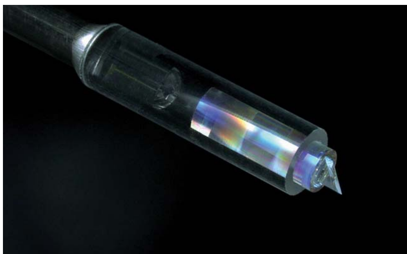
Messsonde zur Innenrundheitsmessung mit 1-mm-Umlenkprisma an der Spitze
