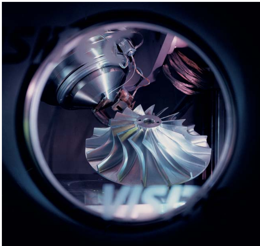
Untersuchung eines Verdichterrads im GK-REM des Fraunhofer IPT
