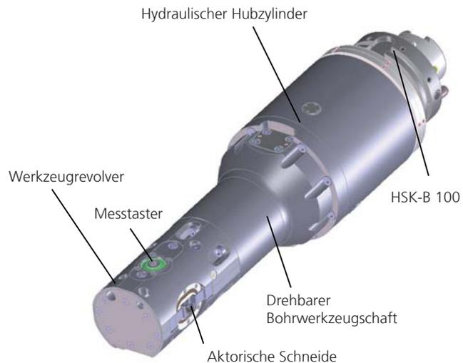
Mechatronisches Bohrwerkzeug zum Ausspindeln von Zylinderhülsen
