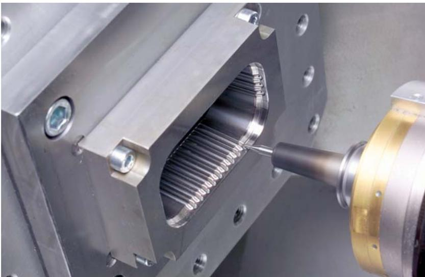
Simultane 5-achsige Hartfräsbearbeitung eines Tiefziehgesenks, Werkstoff: Schnellarbeitsstahl, 65 HRC
