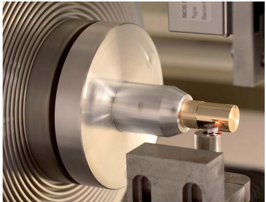
Zerspanung mit monokristallinem Diamantwerkzeug
