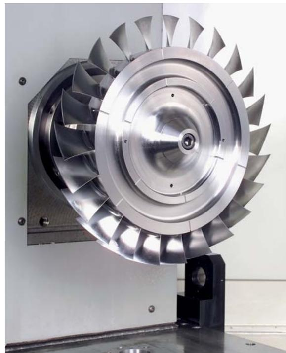
BLISK-Verdichterstufe aus Titan- und Nickelbasislegierung.
