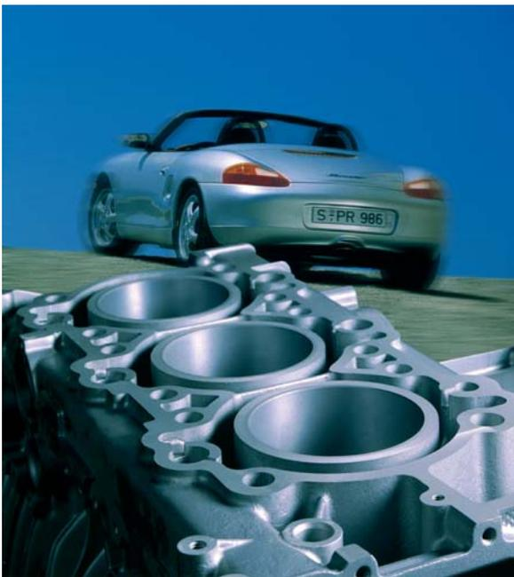
MMC-verstärkte Zylinderlaufflächen im Motorblock.
