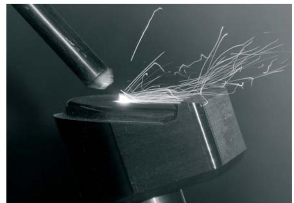
Laserspargieren eines Werkzeugeinsatzes.
