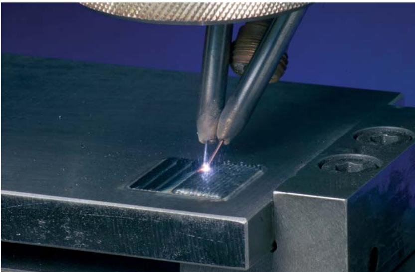
Gradierter Aufbau durch simultanes Doppeldrahtschweißen.
