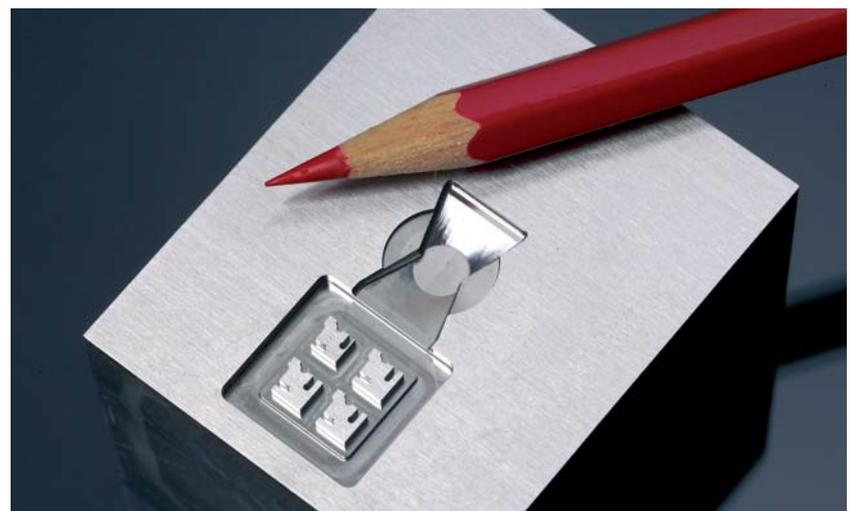
Mikroformeingsatz für die Herstellung von Clipstrukturen. Werkzeugstahl mit einer Härte von 55 HRC.
