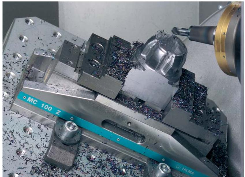
5-achsige Hartfräsbearbeitung eines Stempels für die Kaltmassivumformung, Materialhärte 62 HRC.
