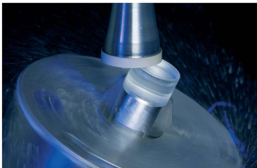
Herstellung einer sphärischen Glasoptik durch ultraschallunterstütztes Schleifen.
