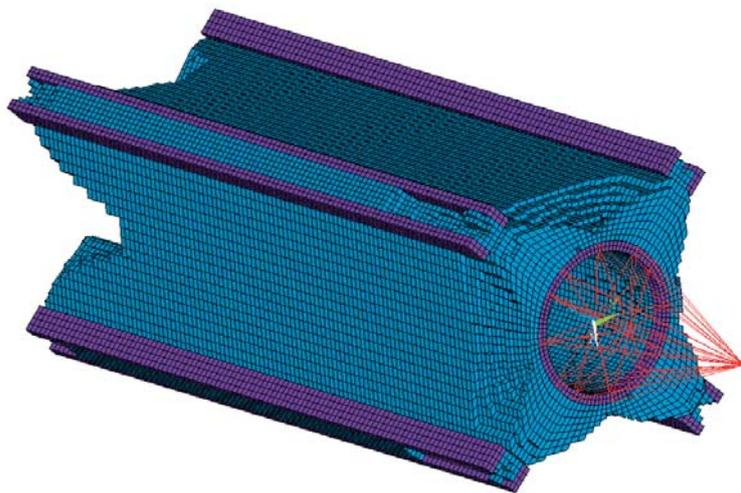
Optimierte Topologie eines Spindelkastens.
