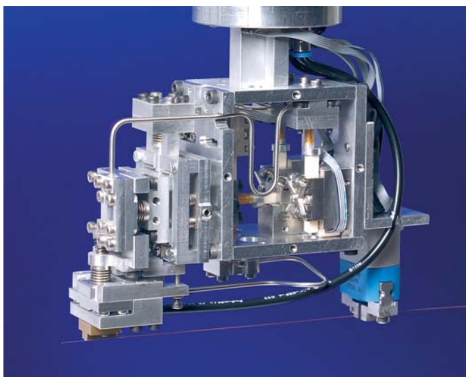
Mehr-Achs-Mikrogreifer zur Handhabung und Feinjustage biegeschlaffer Mikrobauteile.
