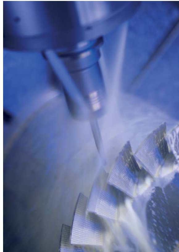
5-Achs-Simultanbearbeitung eines BLISKS.
