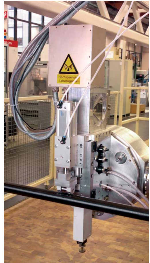
Tapelegekopf zum mikrowellenunterstützten Herstellung von Faser- verbundbauteilen.
