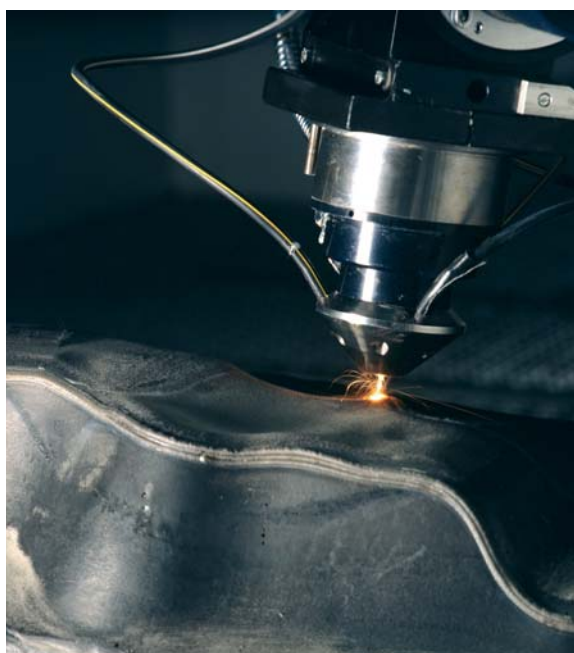
Konturnahe Reparatur eines Schmiedegesenkes.
