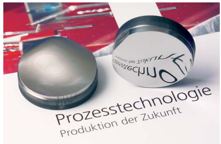
Gefräste und automatisch polierte Freiformfläche.
