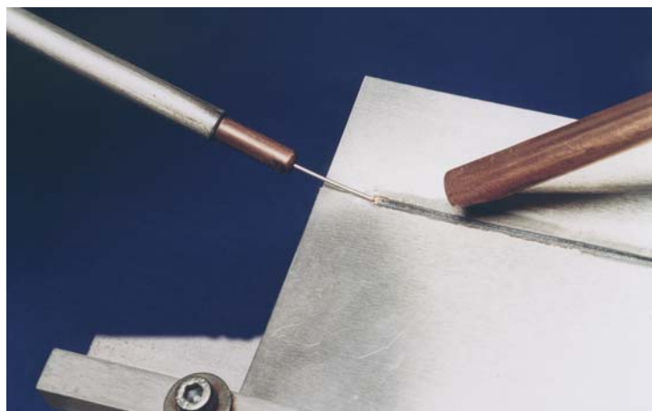
Laserstrahllöten von Aluminiumblechen.
