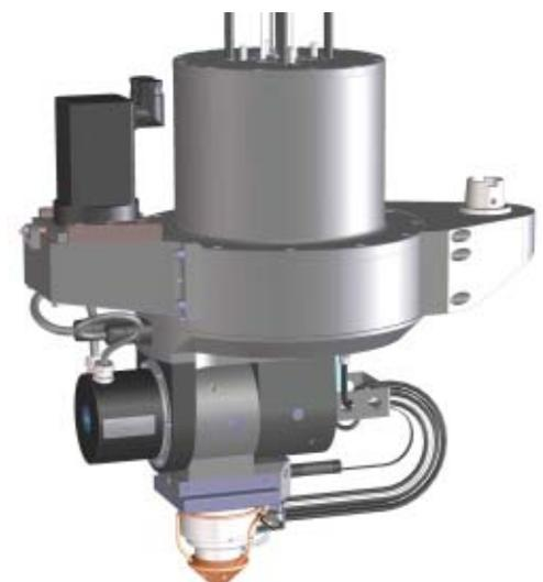
2-Achs-Laserbeschichtungskopf zur Freiformbeschichtung
