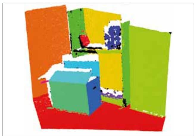
Segmentierte Punktwolke einer Büroszene mit einem Karton im Vordergrund. Die Farben kodieren die Ebenenzuordnung.
