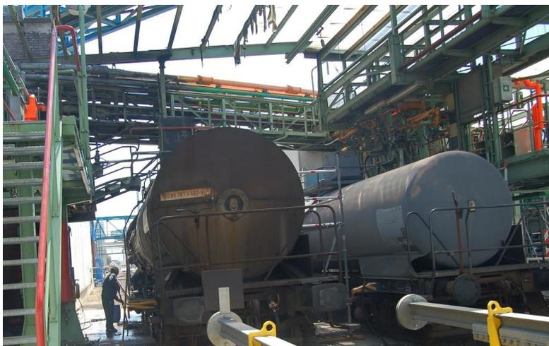
*Der Brandort: Beim Entladen eines Kesselwagens lief Phosphor aus der Leitung und entzündete sich.* FOTO: LANXESS
